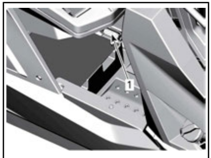
1. Caixa de fusíveis auxiliar
