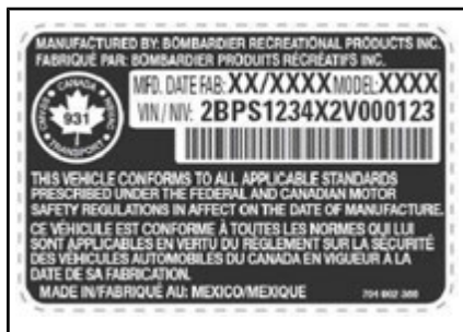
SITUAZIONE TIPICA — ETICHETTA DEL NUMERO DI SERIE DEL VEICOLO SOTTO IL VANO PORTAOGGETTI
