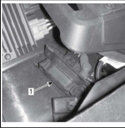
1. Scatola di fusibili ausiliaria
