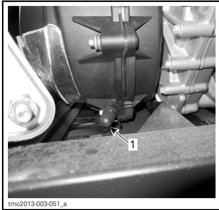
1. Drain de la transmission CVC
