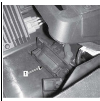
1. Caja de fusibles auxiliar
