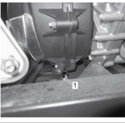
1. Drenaje de la CVT
