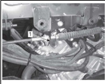
LATERAL IZQUIERDO — CILINDRO DE LA PARTE DELANTERA
