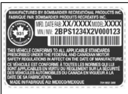
TYPBILD — DEKAL FÖR FORDONETS TILLVERKNINGSNUMMER UNDER HANDSKFACKET
