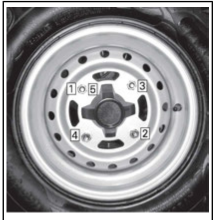
SEQUENZA DI SERRAGGIO
