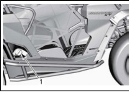
1. Tappo del serbatoio del carburante
