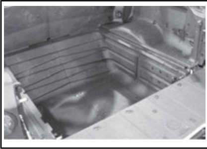
KUORMATIILA ILMAN LATTIAA/ VÄLILEVYÄ
