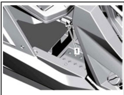
1. Caixa de fusíveis auxiliar
