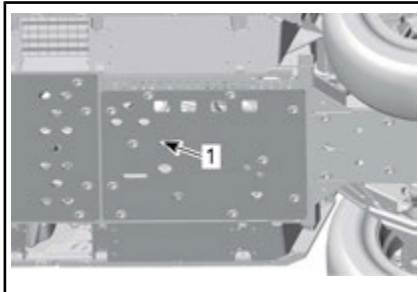
1. Budo de drenagem do óleo
