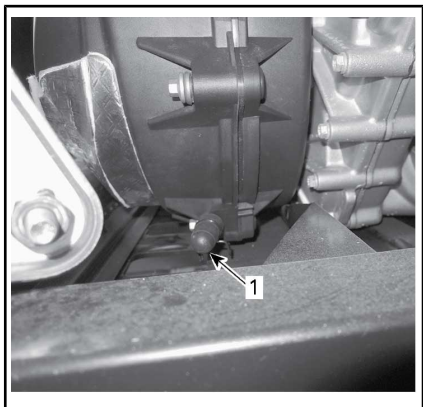
1. Drenagem da CVT
