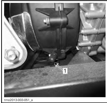
1. Drain de la transmission CVC
