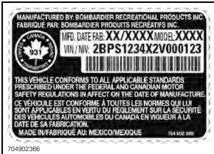
704902366 TIPIQUE — AUTOCOLLANT DE NUMÉRO DE SÉRIE DU VÉHICULE SOUS LA BOÎTE À GANTS
