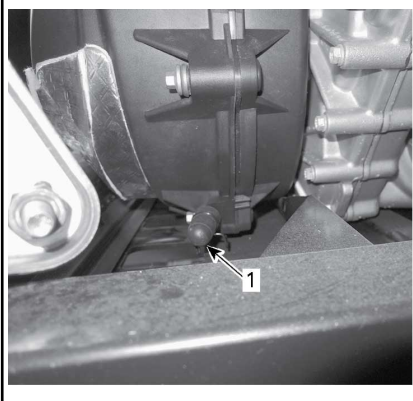
1. Drenaje de la CVT
