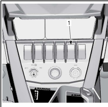
1. Interruptor de ACS
