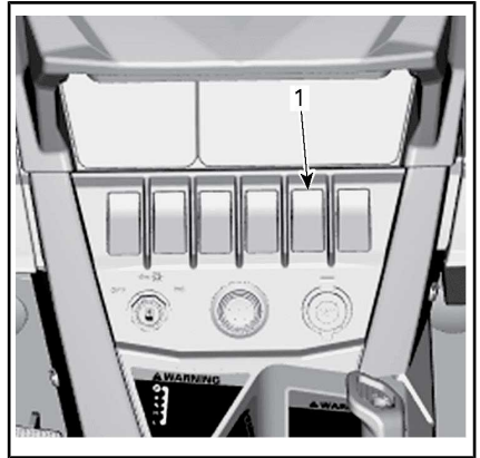
1. Interruptor de ACS
