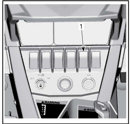
1. Interruptor de ACS
