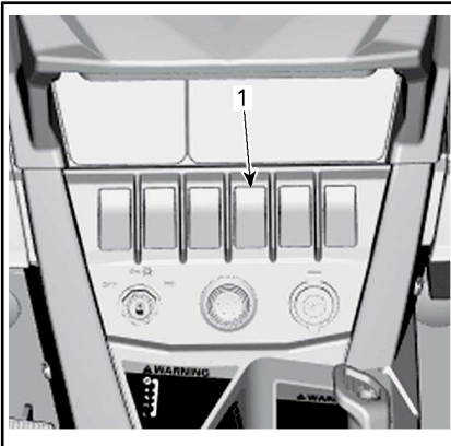
1. Interruptor de DPS
