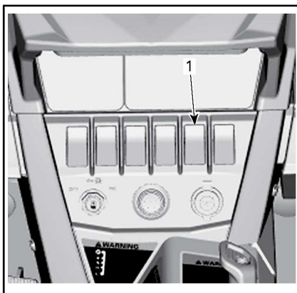
1. Interruptor de ACS
