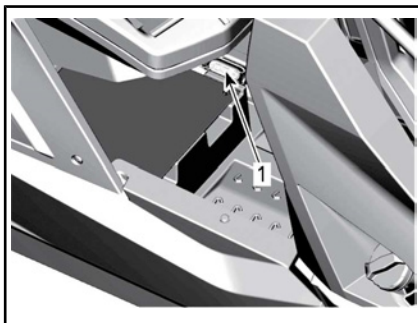
1. Scatola di fusibili ausiliaria
