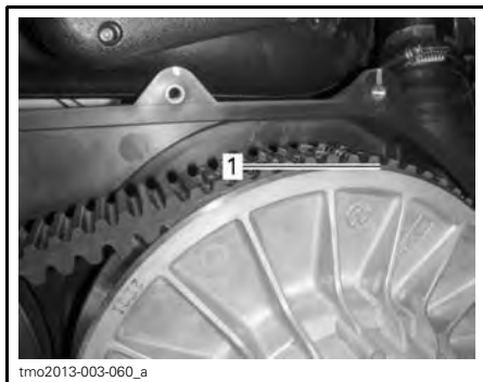
1. Partie inférieure des dents égale avec la surface externe de la courroie d'entraînement
