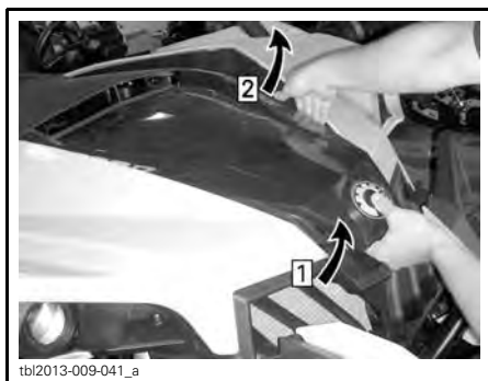
Étape 1: Continuer de soulever la partie avant du couvercle d'entretien Étape 2: Dégager doucement la patte du couvercle de sa rondelle de caoutchouc puis dégager la patte de l'autre côté
