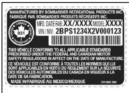
TYPISCH — HINWEISSCHILD MIT FAHRZEUGSERIENNUMMER UNTER HANDSCHUHFACH
