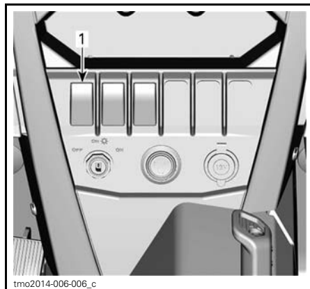
1. Interrupteur de feux de détresse
