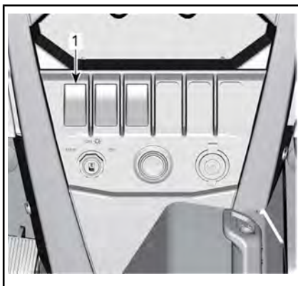
1. Interruptor de advertencia de peligro
