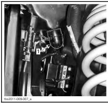
DRAIN PLUG ACCESS FROM LH SIDE OF VEHICLE
