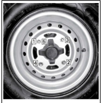
REIHENFOLGE BEIM ANZIEHEN
