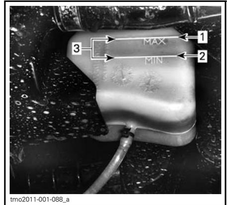
**TANQUE DE EXPANSÃO DO SISTEMA DE ARREFECIMENTO**
