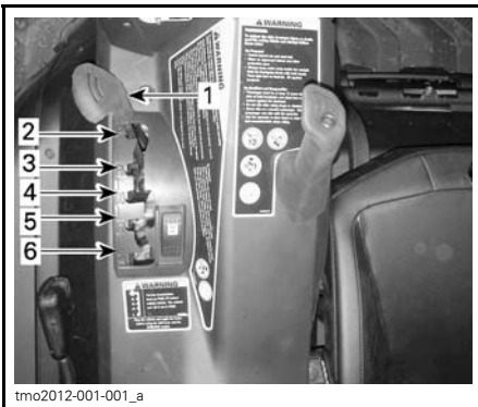
1. Schalthebel 2. Park-Position 3. Rückwärts 4. Neutral 5. Bereich für hohe Geschwindigkeit (vorwärts) 6. Bereich für niedrige Geschwindigkeit (vorwärts)
