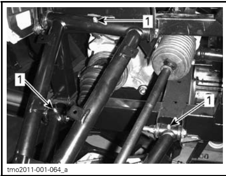
VORDERRADAUFHÄNGUNG - TYPISCH 1. Schmierlager
