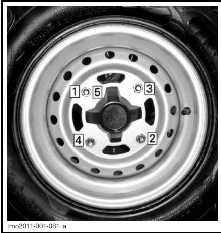
REIHENFOLGE BEIM ANZIEHEN
