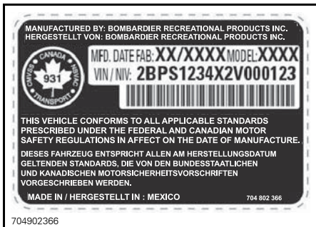
TYPISCH — HINWEISSCHILD MIT FAHRZEUGSERIENNUMMER UNTER HANDSCHUHFACH
