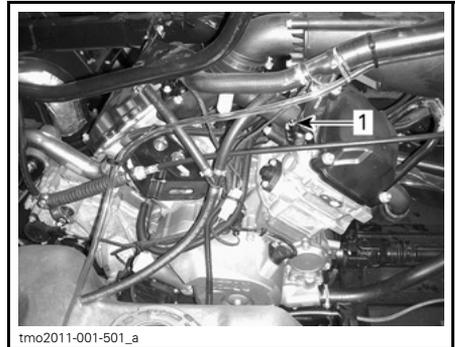
1. Entlüftungsschraube des vorderen Zylinders
