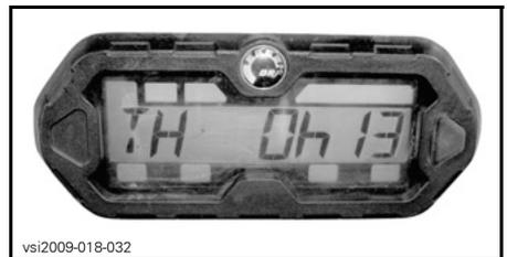
Drücken Sie die Auswahlstaste und HALTEN Sie sie 2 Sekunden gedrückt, um den Stundenzähler zurückzusetzen.
