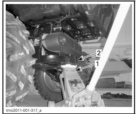
1. Hydraulischer Wagenheber
