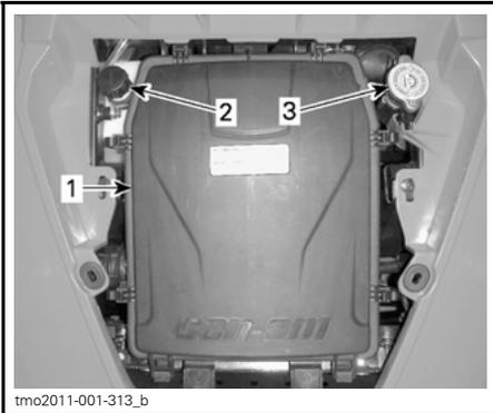
1. Deckel des Luftfilterkastens
