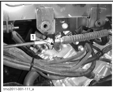
LINKERKANT — VOORSTE CILINDER 1. Bougie
