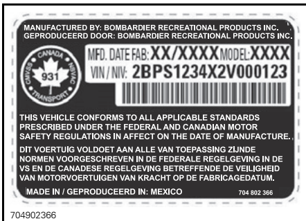
704902366 TYPISCH — LABEL MET SERIENUMMER VOERTUIG ONDER HANDSCHOENNAK
