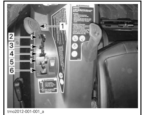
1. Levier de changement de vitesse 2. Stationnement 3. Marche arrière 4. Point mort 5. Rapport supérieur (marche avant) 6. Rapport inférieur (marche avant)
