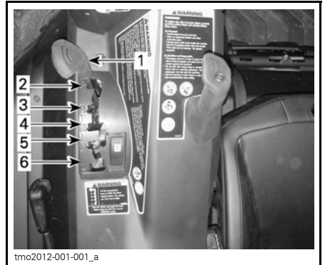
1. Vaihdevipu 2. Parkki 3. Peruutus 4. Vapaalla 5. Nopea alue (eteenpäin) 6. Hidas alue (eteenpäin)
