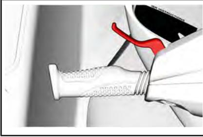
4. Lorsque le message **NEUTRALISATION iBR - APPUYEZ SUR MODE** apparaît dans l'indicateur multifonctionnel, appuyez sur le bouton MODE.
