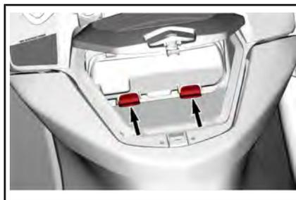
Une mousse de protection située à l'intérieur du compartiment étanche protège les téléphones. Assurez-vous que le téléphone intelligent soit maintenu en place par la mousse et non pas les rebords du compartiment et que vous puissiez fermer le couvercle. Vérifiez toujours que la mousse soit complètement sèche avant d'utiliser le compartiment.
