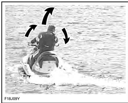
ハンドルバーを回すと、ジェットポンプノズルが軸を中心に向きを変え、ウォータークラフトの進行方向を制御します。ハンドルバーを右に切ると、ウォータークラフトは右へ旋回し、左に切れば左に旋回します。操船にはスロットルを回していることが必要です。
