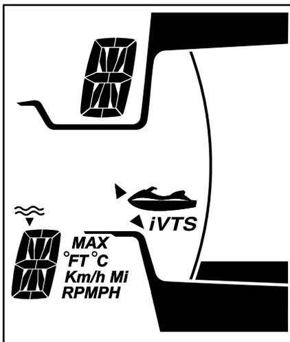
中央のトリム位置の選択は、実際のトリム位置によって異なります。中央のトリム位置よりも下にある場合はVTSの上ボタンをダブルクリックし、中央のトリム位置よりも上にある場合はVTSの下ボタンをダブルクリックします。
