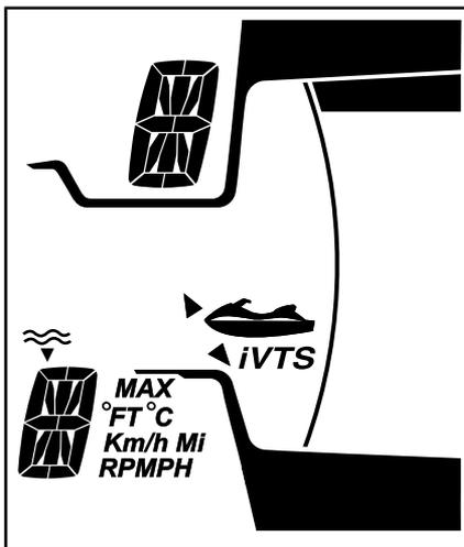
記録された最低のトリムポジションを選択するには、VTS[下]ボタン（ハウダウン）をダブルクリックします。
