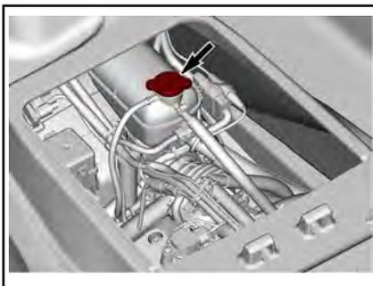
ウォータークラフトが水平になっている状態で、エンジンが冷えているとき、クーラントのレベルはリザーバーのMINとMAXのマークの間になければなりません。
