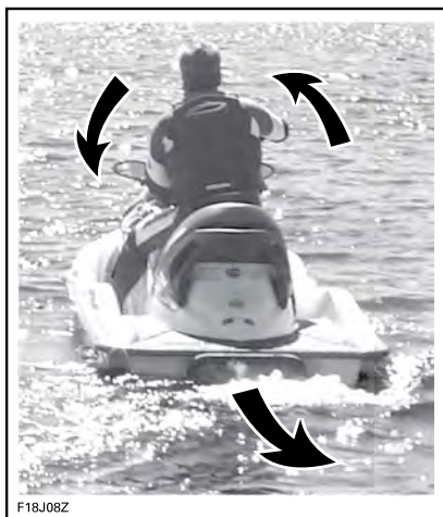
TYPBILD - STYRRIKTNINGEN OMKASTAD VID BACKNING
