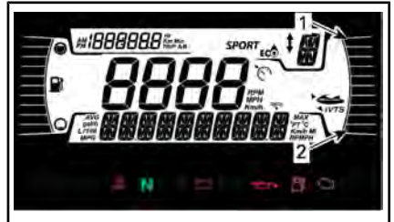
CENTRALINA INFORMAZIONI — INDICATORE POSIZIONE VTS
