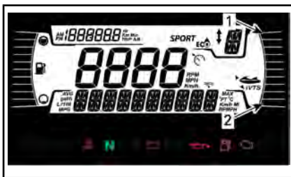
CENTRALINA INFORMAZIONI — INDICATORE POSIZIONE VTS
