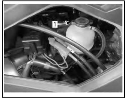
1. Tappo del serbatoio a espansione
