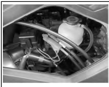
VANO MOTORE - COPERCHIO DI ACCESSO SINISTRO RIMOSSO
