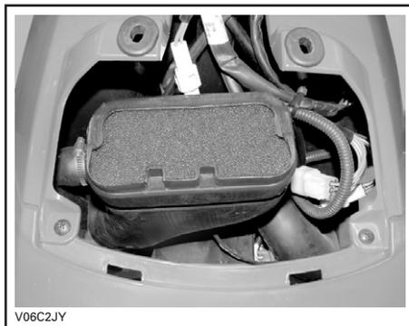
Solução de limpeza (P/N 219 700 341) ou equivalente em um balde. Colocar o filtro de molho.
