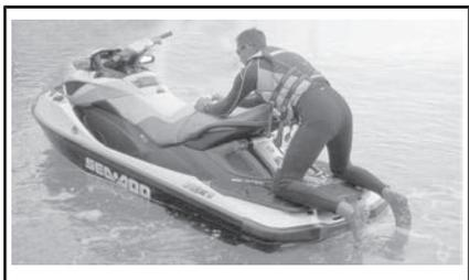
シートのストラップを持ってバランスを保ちながら、シートのいずれかの側でフットボードの上へと前進してください。
