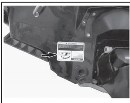
このエンジンには転覆保護システム (T.O.P.S.™) が装備されています。ウォータークラフトがひっくり返ると、エンジンは自動的に停止します。
