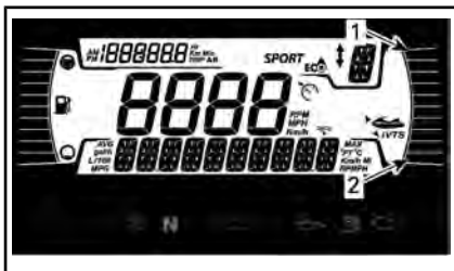
インフォメーションセンター-VTSポジションインジケータ
