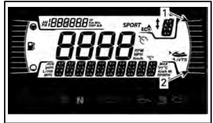
CENTRALINA INFORMAZIONI — INDICATORE POSIZIONE VTS
