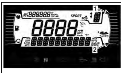
CENTRALINA INFORMAZIONI — INDICATORE POSIZIONE VTS
