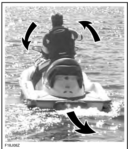
典型示例 — 后退时转向方向相反
