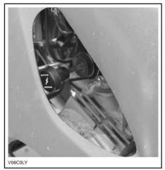
CHOKE LEVER IN THE FULL CHOKE POSITION
