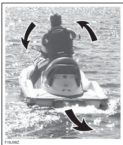
TYPISCH - LENKRICHTUNG BEIM ZURÜCKSETZEN UMGEKEHRT
