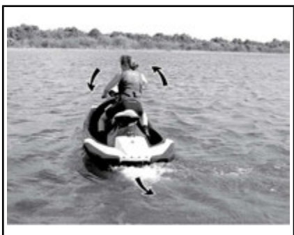
CONFIGURAZIONE TIPICA - LA DIREZIONE DI VIRATA È INVERTITA QUANDO SI PROCEDE ALL'INDIETRO
