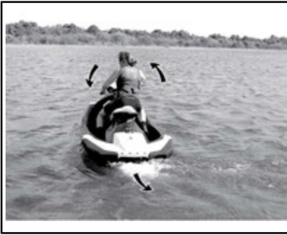
TYYPILLINEN - PERUUTETTAESSA OHJAUSSUUNTA ON PÄINVASTAINEN
