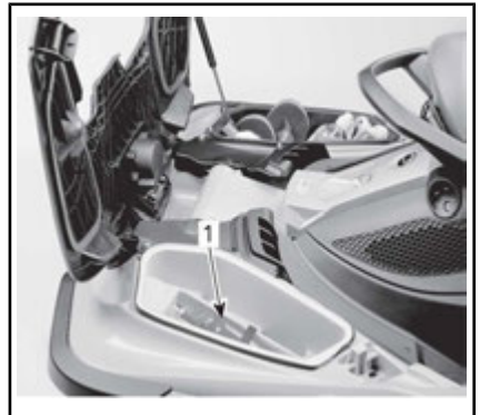
1. Placering av hållare för brandsläckare
