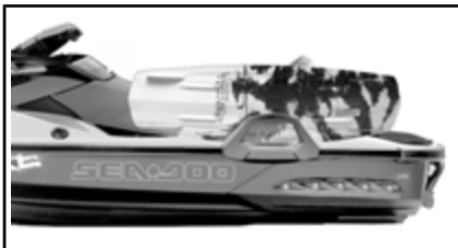
WAKEBOARD INSTALLERAD MED FENORNA UTÅT
