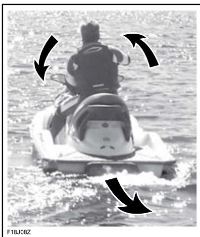
TYPBILD - STYRRIKTNINGEN OMKASTAD VID BACKNING
