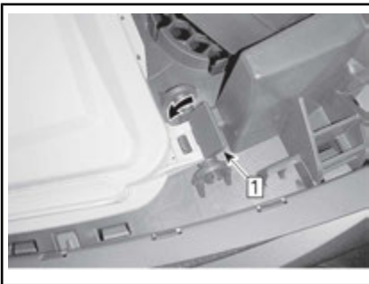
Steg 1: Tryck nedåt på låsen för att säkra
