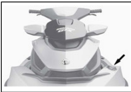
TYPEBILDE – Plassering av drivstofftanklokk
