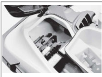
TILGANG TIL BATTERI OG SIKRINGER – HØYRE OPPBEVARINGSBOKS TATT AV
