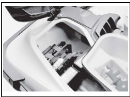
ACCESSO A BATTERIA E FUSIBILI - CESTELLO PORTAOGGETTI DI DESTRA RIMOSSO
