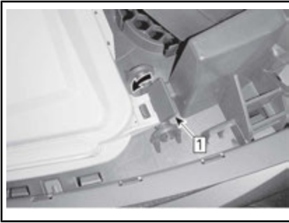
Fase 1: Spingere in basso i dispositivi di bloccaggio per fissare.
