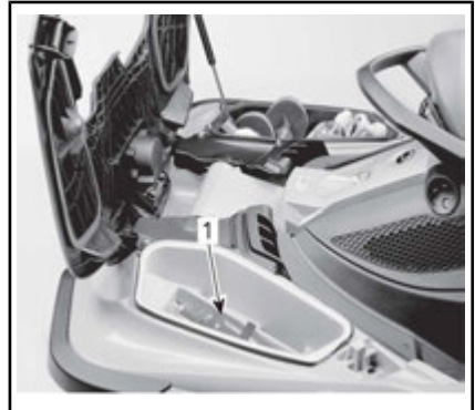
1. Ubicazione del supporto estintore
