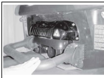
SCALINO D'IMBARCO TENUTO GIÙ IN POSIZIONE APERTA PER SALIRE A BORDO DIRETTAMENTE DALL'ACQUA
