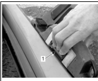
RIMOZIONE DEL SUPPORTO PER WAKEBOARD
