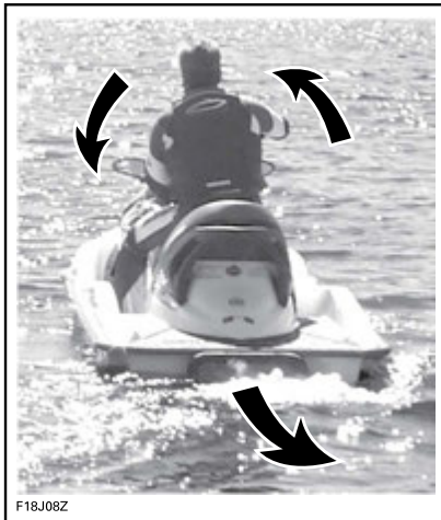
CONFIGURAZIONE TIPICA - LA DIREZIONE DI VIRATA È INVERTITA QUANDO SI PROCEDE ALL'INDIETRO
