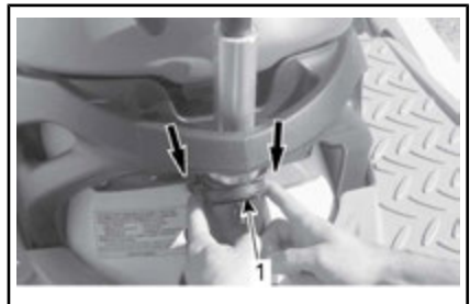
SPINGERE VERSO LA PARTE ANTERIORE PER SBLOCCARE E RIMUOVERE IL PUNTELLO.
