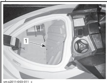
ДОСТУП К АКБ И ПРЕДОХРАНИТЕЛЯМ, НОСОВОЙ БАГАЖНЫЙ ОТСЕК
