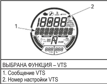
3. Убедитесь в функционировании системы VTS, взглянув на изменение показаний индикатора дифферента на цифровом дисплее.
