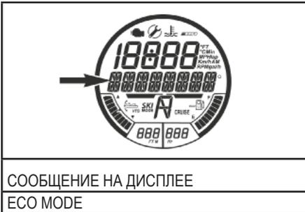
Включение режима экономии топлива дополнительно подтверждается включением соответствующего индикатора.
