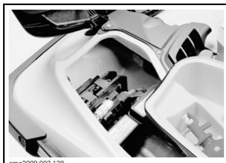
ÅTKOMST TILL BATTERI OCH SÄKRINGAR - HÖGER FÖRVARINGSLÅDA DEMONTERAD
