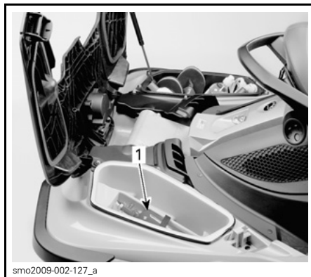
1. Placering av hållare för brandsläckare
