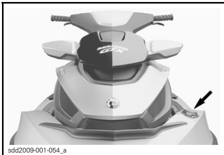
sdd2009-001-054_a TYPEBILDE – PLASSERING AV DRIVSTOFFTANKLOKK
