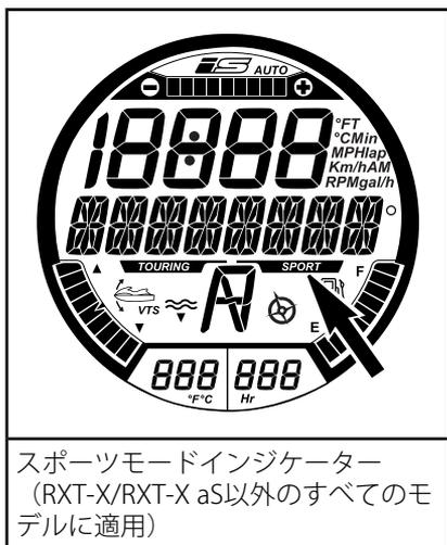
スポーツモードの操作を選択すると、スポーツモードインジケータが点灯し、スポーツモードを解除するか、ウォータークラフトを停止するまで点灯し続けます。
