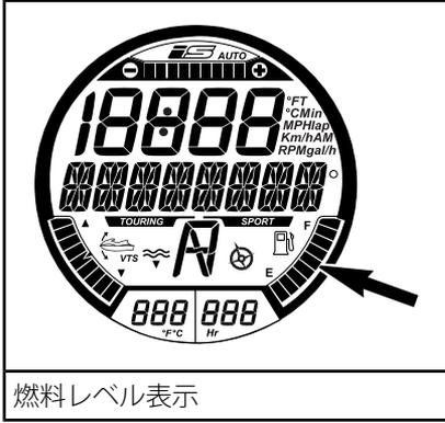
燃料タンクが満杯の場合、インジケータの8セグメント (バー) 全部が点灯します。トップのセグメントは使用されません。
