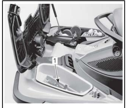
1. Ubicazione del supporto estintore
