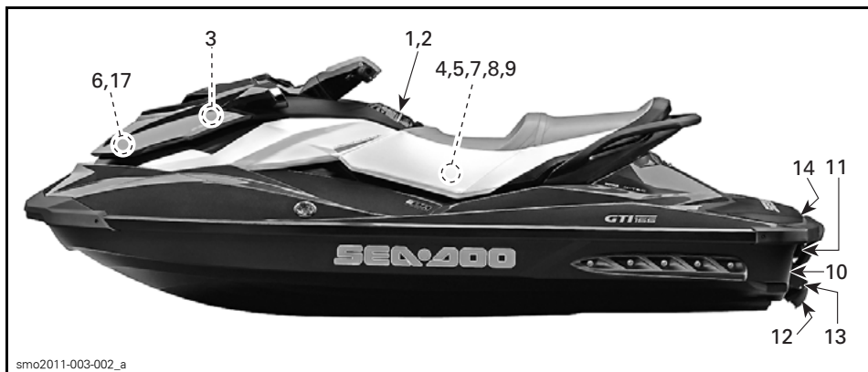
VATTENSKOTERNS SÄKERHETSDEKALERS PLACERING - GTI-MODELLER
