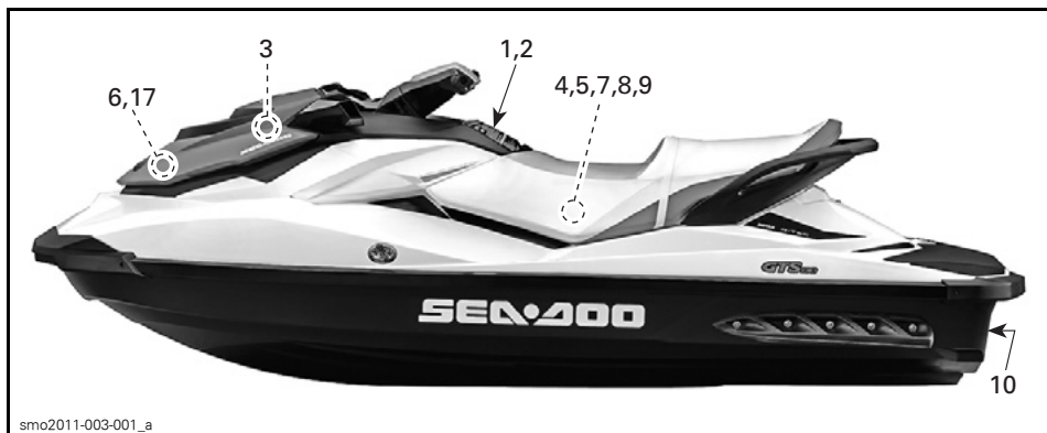
VATTENSKOTERNS SÄKERHETSDEKALERS PLACERING - GTS-MODELLER
