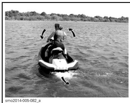
TYPBILD - STYRRIKTNINGEN OMKASTAD VID BACKNING
