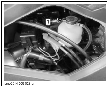
1. Bouchon du réservoir d'expansion
