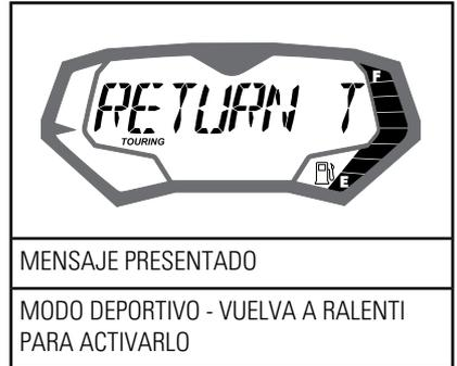
Suelte el acelerador. Cuando el motor vuelva a la posición de ralentí, se activará el modo DEPORTIVO.
