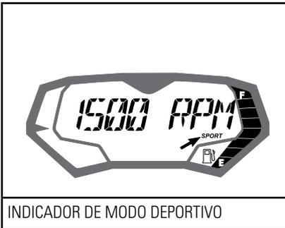
**NOTA:** El indicador de modo DEPORTIVO se encenderá y no se apagará mientras se mantenga activo el modo deportivo. Si el acelerador no se suelta completamente y el motor no está funcionando al ralentí, no puede activarse el modo DEPORTIVO. En el indicador multifunción, aparecerá el siguiente mensaje:
